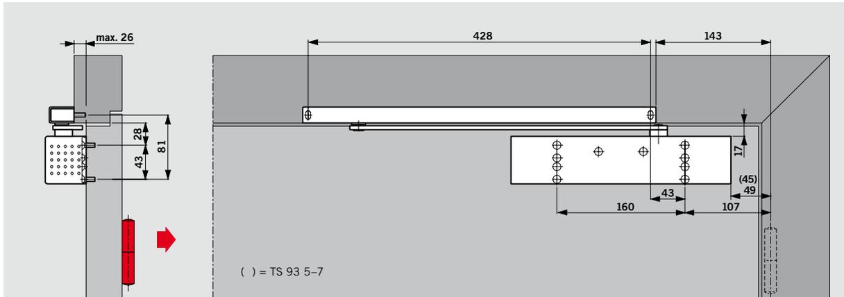
Türblattmontage (Normalmontage) des DORMA TS 93 G auf der Bandgegenseite. Abhängig von den baulichen Gegebenheiten, ist der Türöffnungswinkel auf ca. 120° bis 145° begrenzt. Um Beschädigungen der Tür bzw. des Türschließers
