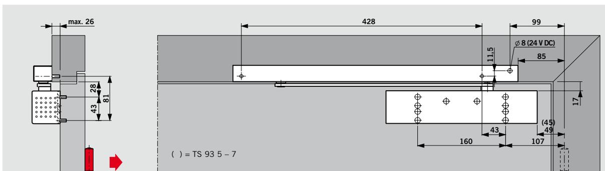
Türschließer DORMA **TS 93 G** mit Gleitschiene DORMA G-EMF, Montage auf der Bandgegenseite
