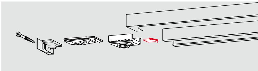
Die Rastfeststelleinheit **DORMA RF** ermöglicht ein exaktes Feststellen von Türen ohne Rückfederung bis zu einem Öffnungswinkel von ca. 150°. Die Rastfeststellung lässt sich bei Bedarf vom Benutzer einfach ein- und ausschalten, und die Ausrück-
