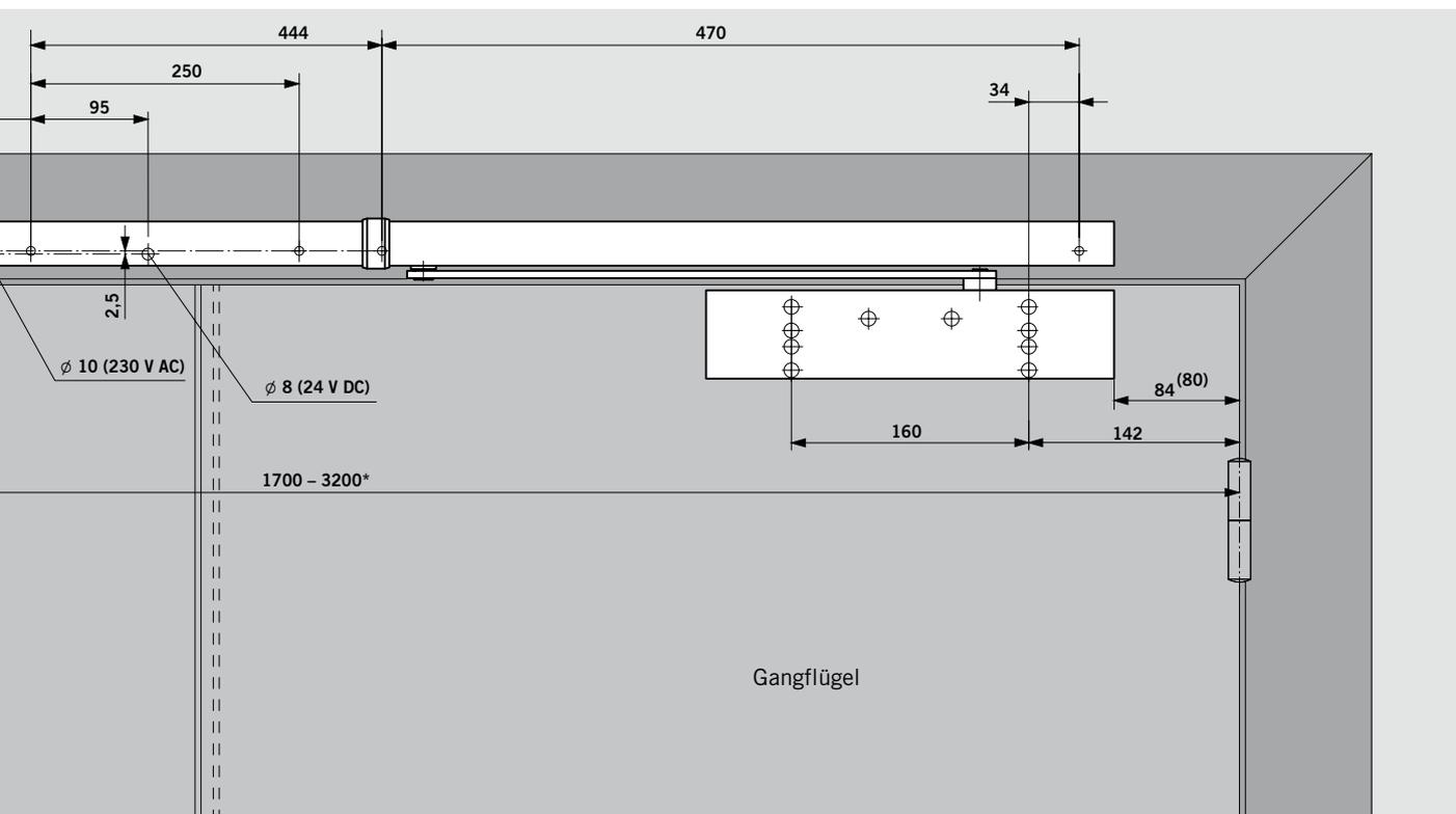
\* Bei besonders großen und schweren Türen (über 2500 mm) empfehlen wir, an Stelle der elektromechanischen Feststellung Haftmagnete DORMA EM einzusetzen.
