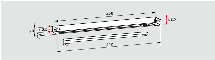
Die Gleitschiene **DORMA G-N** umfasst Hebel, Gleitschiene, Gleitstück, Befestigungsstücke, Schrauben und Endkappen. Die Gleitschiene DORMA G-N ist sowohl für DIN-L- als auch für DIN-R-Türen verwendbar und kann mit allen Türschließer-
