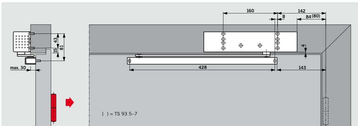
Sturzmontage (Kopfmontage) des DORMA TS 93 B auf der Bandgegenseite. Öffnungsdämpfung und Schließverzögerung sind bei dieser Montageart nicht wirksam. Abhängig von den baulichen Gegebenheiten, ist der Türöffnungswinkel auf ca. 120° bis 145° begrenzt.
