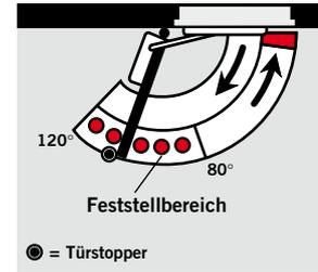
Die Gleitschiene **DORMA G-EMR** ermöglicht es, Feuer- und Rauchschutztüren so auszurüsten, daß sie sich exakt feststellen lassen und völlig unabhängig von anderen Systemen überwacht und gesteuert werden. Der Feststellpunkt ist auf einen Öffnungswinkel zwischen ca. 80° und 120° einstellbar.
