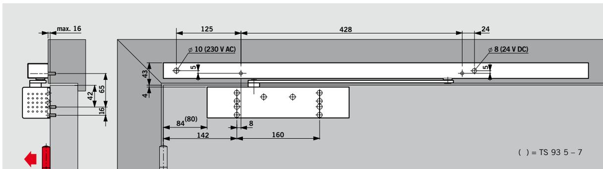
Türschließer DORMA **TS 93 B** mit Gleitschiene DORMA G-EMR, Montage auf der Bandseite
