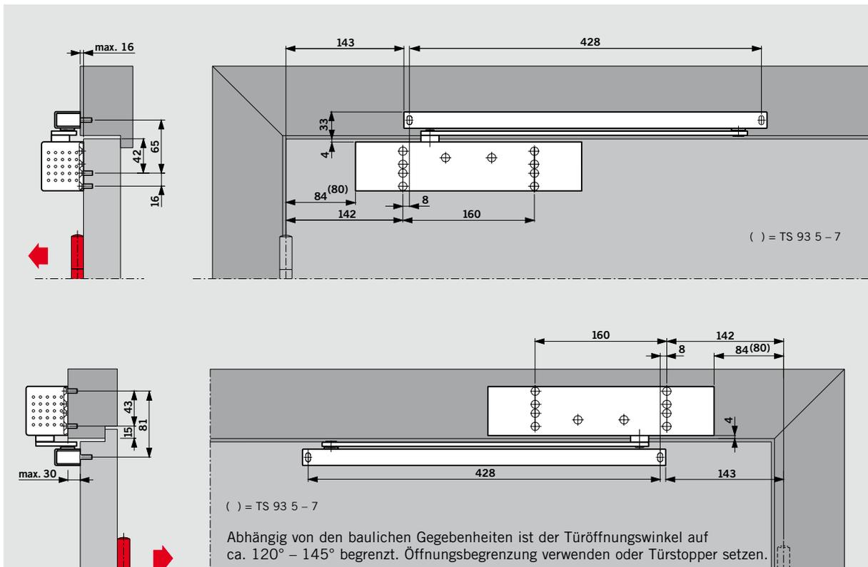
Türschließer DORMA **TS 93 B** mit Gleitschiene DORMA G-N
