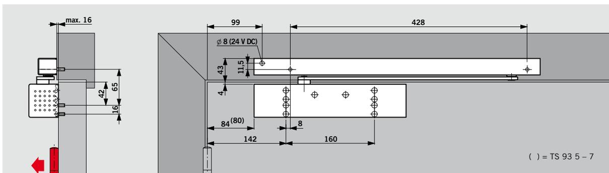
Türschließer DORMA **TS 93 B** mit Gleitschiene DORMA G-EMF, Montage auf der Bandseite
