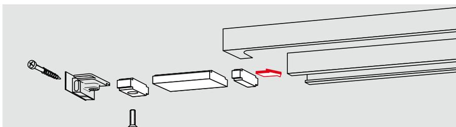
Zubehör für DORMA Gleitschiene G-N, RF: **Öffnungsbegrenzung** zum nachträglichen Einschub in die Gleitschiene. Einstellbar zwischen 80° und **max. 120°**.
