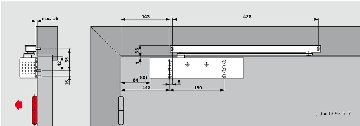
Türblattmontage (Normalmontage) des DORMA TS 93 B auf der Bandseite. Unter entsprechenden baulichen Voraussetzungen ist bei dieser Montageart ein Öffnungswinkel von 180° möglich. In den meisten
