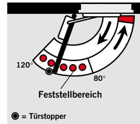
Die Gleitschiene **DORMA G-EMF** ermöglicht ein exaktes Feststellen der Tür ohne Rückfederung. Der Feststellpunkt ist auf einen Öffnungswinkel zwischen ca. 80° und 120° einstellbar.
