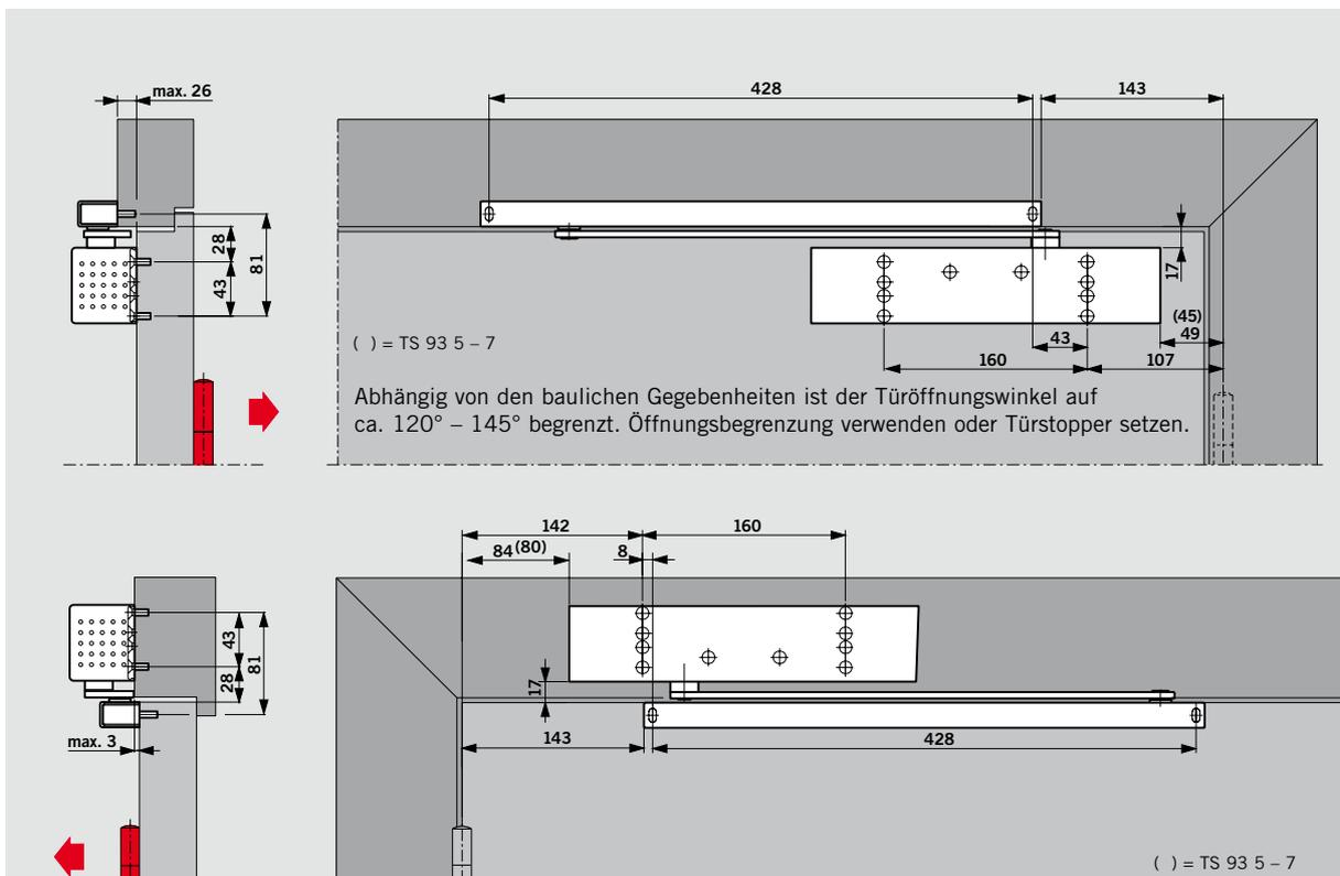
Türschließer DORMA **TS 93 G** mit Gleitschiene DORMA G-N
