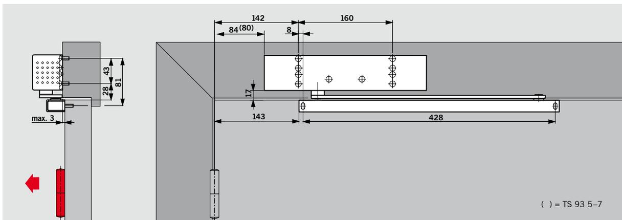
Sturzmontage (Kopfmontage) des DORMA TS 93 G auf der Bandseite. Unter entsprechenden baulichen Voraussetzungen ist bei dieser Montageart ein
