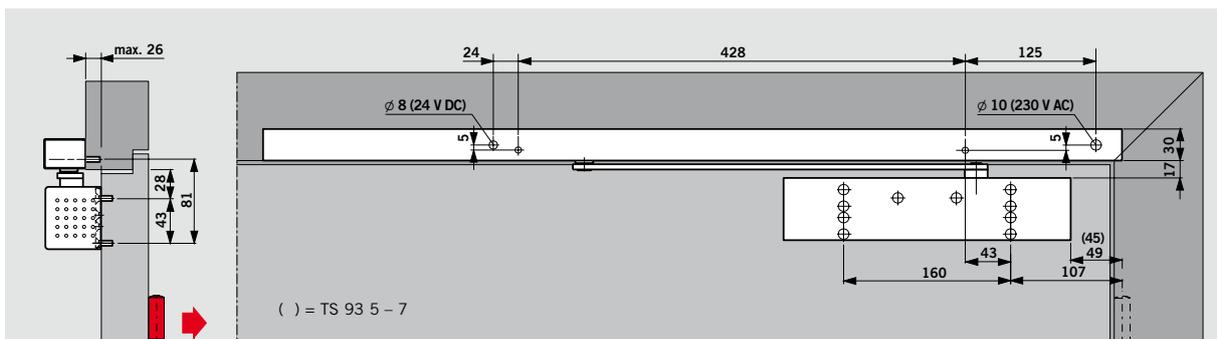
Türschließer DORMA **TS 93 G** mit Gleitschiene DORMA G-EMR, Montage auf der Bandgegenseite
